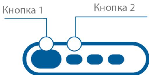
2. Через 3 секунды успешная регистрация будет подтверждена коротким звуковым сигналом брелока, 2 вспышками светодиода сервисной кнопки или трансивера и 2 звуковыми сигналами. Если брелок не зарегистрировался, то последуют 4 звуковых сигнала брелока.
